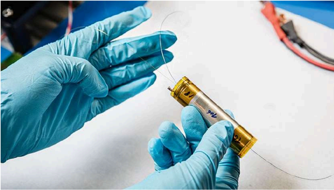
La fibre optique insérée dans la batterie recueille des signaux infrarouges qui délivrent des informations sur son fonctionnement. © Frédérique PLAS / CSE / CNRS Photothèque
