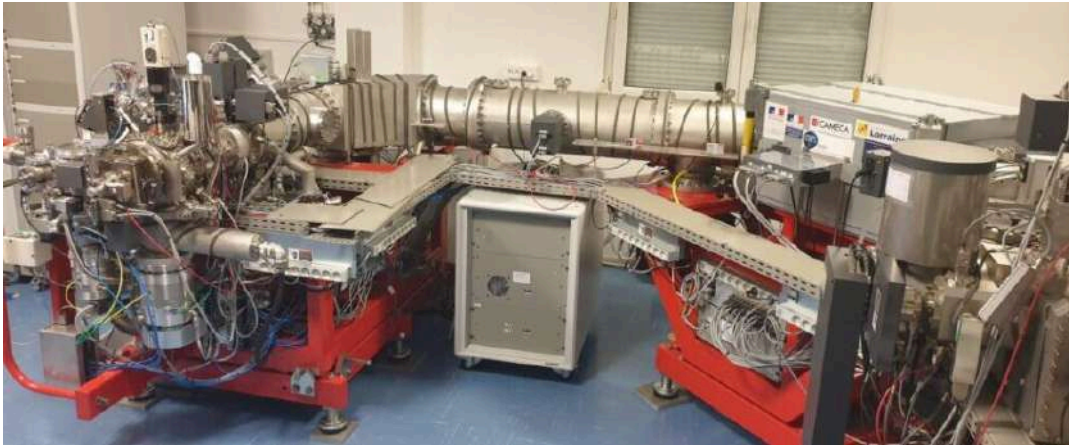
La plateforme LG-SIMS-Nancy est spécialisée dans l'analyse isotopique et élémentaire in situ par microsonde ionique à haute résolution spatiale. © CRPG
