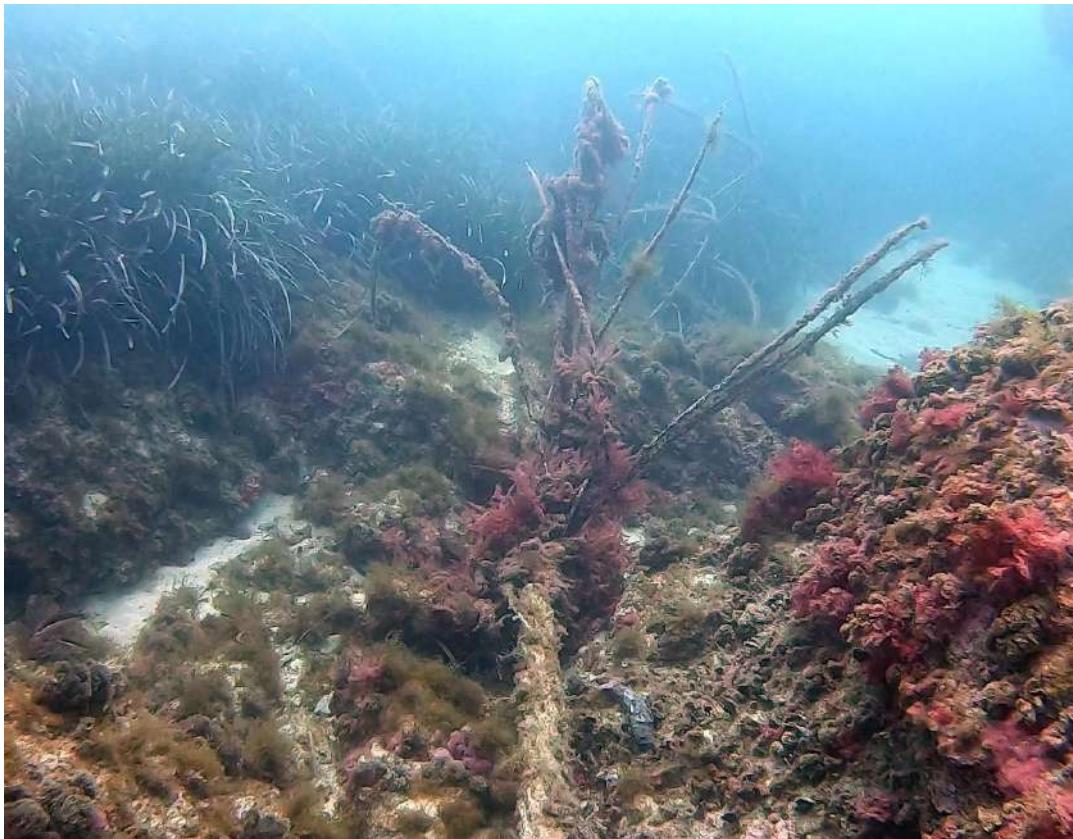
Fig. 2. Câble France-Algérie détoronné. Crédit : PMCB.
