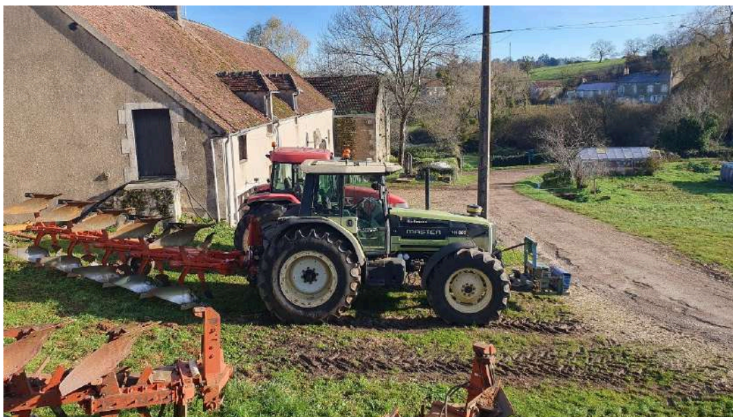
Figure 10. Une charrue cinq socs. La formidable montée en puissance des machines agricoles durant les 60 dernières années est une des caractéristiques marquantes de la modernisation de l'agriculture et de la dynamique du productivisme. Attelée, une charrue 5 socs ; on trouve des charrues jusqu'à 8 socs. Source : A. Gonin, novembre 2024.
